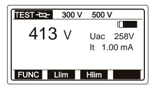
Fig. 11. Breakdown voltage displayed
